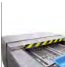
SAFETY DEVICE FOR INLET CONVEYOR / SICHERHEITSELEMENT AM ANFANG DES BANDES
